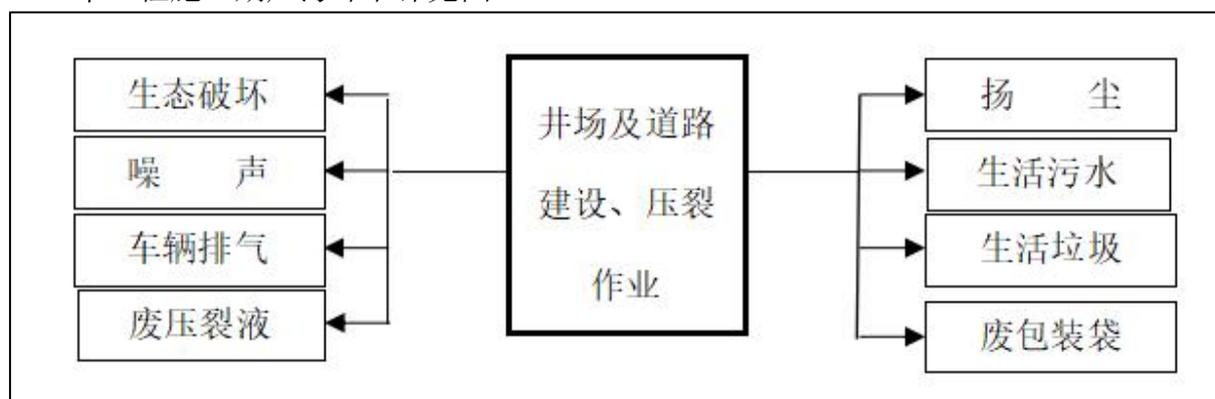
图 2.4-2 施工期产污环节示意图
