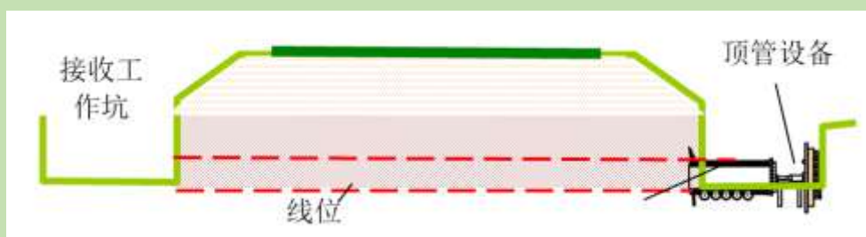
图 3.7-4 顶管施工示意图
