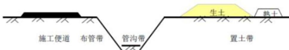
图 3-4-11 管道施工平面布置图
