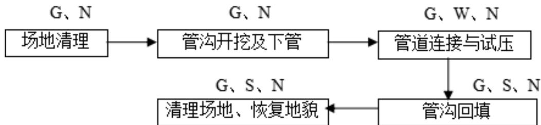
图 3.3-8 管线工程施工工艺流程及排污节点图
