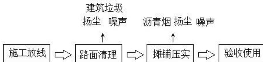
图3.6-7 道路维修改造施工工艺流程图
