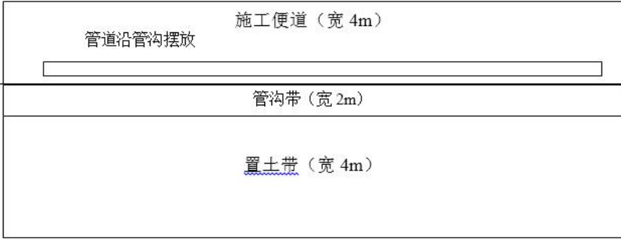
图 3.8-4 管道开挖施工平面布置示意图
