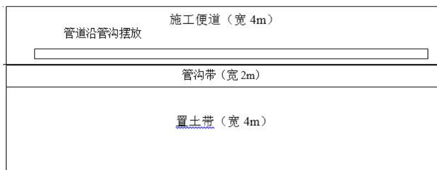
图 3.8-3 管道开挖施工平面布置示意图
