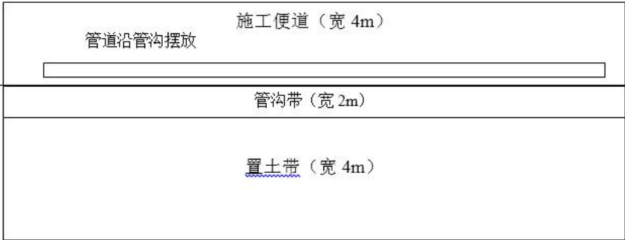
图 3.8-4 管道开挖施工平面布置示意图
