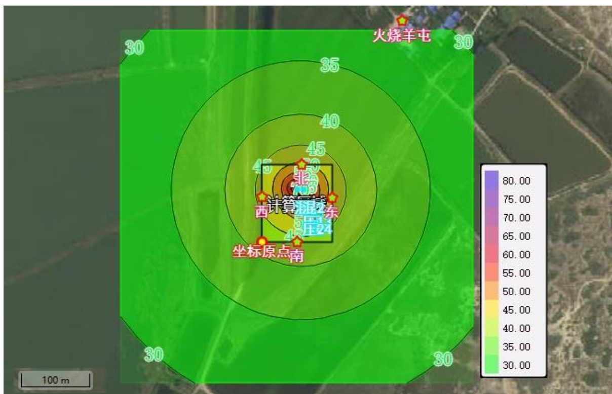
图 5.4-2 压裂施工期井场噪声预测图
