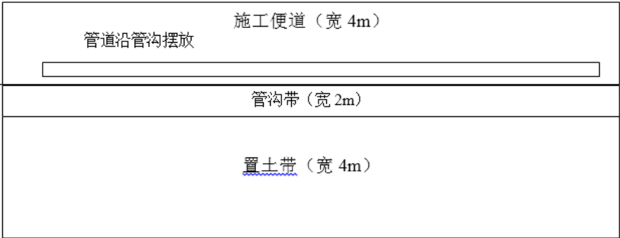
图 3.8-3 管道开挖施工平面布置示意图
