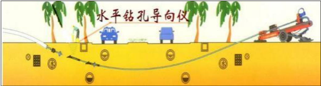
图 3.6-5 定向钻穿越施工示意图
