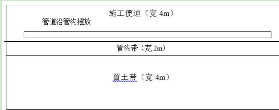
图 3.8-4 管道开挖施工平面布置示意图
