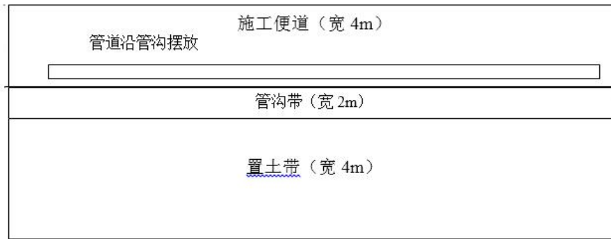
图 3.8-3 管道开挖施工平面布置示意图
