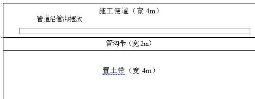
图 3.8-3 管道开挖施工平面布置示意图
