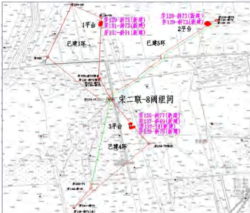
图 2.3-2 (4) 宋二联-8 阀组间新井集油系统布局示意图
