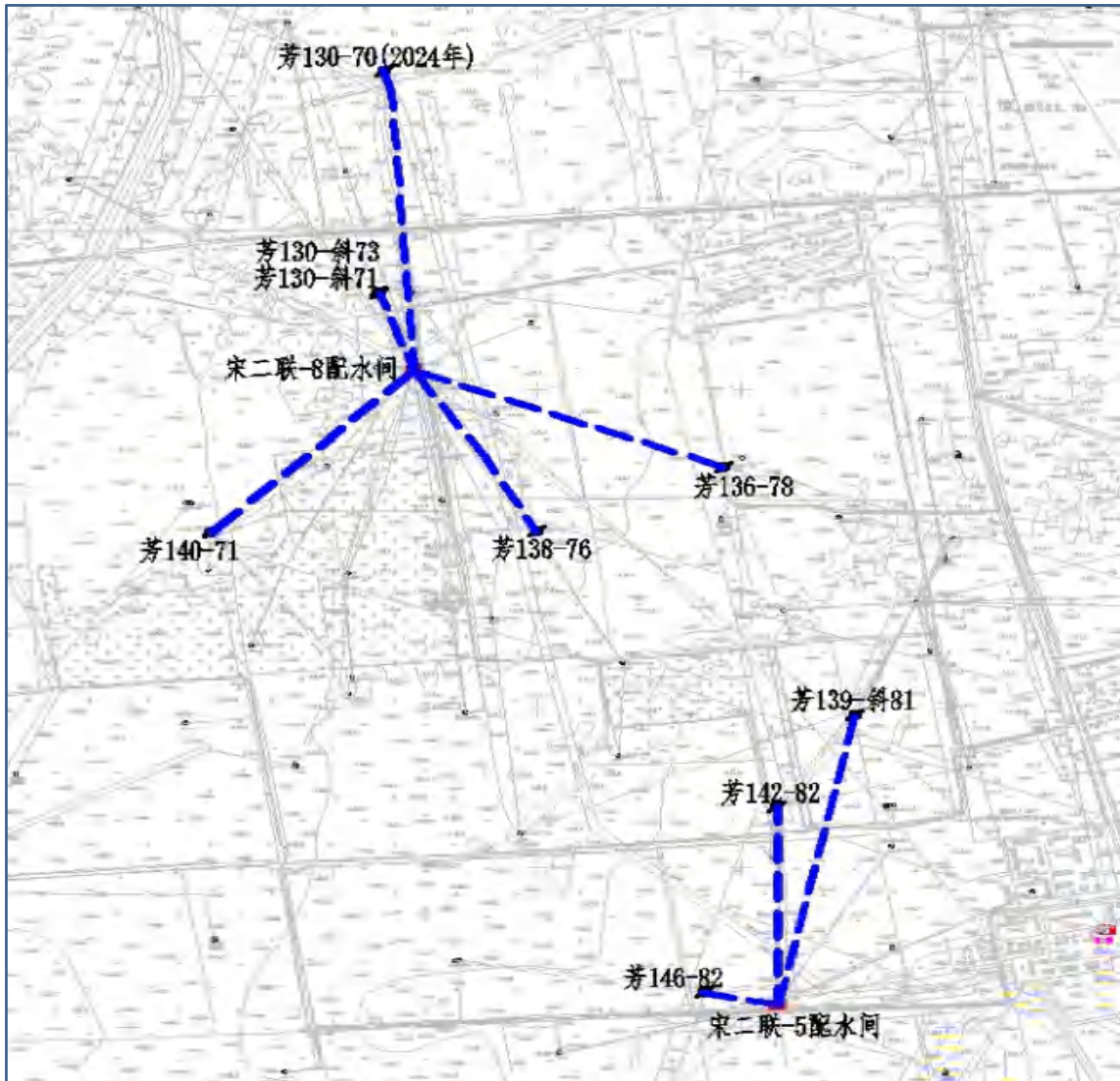
图 2.3-3 注水井挂接配水间的井网布置图
