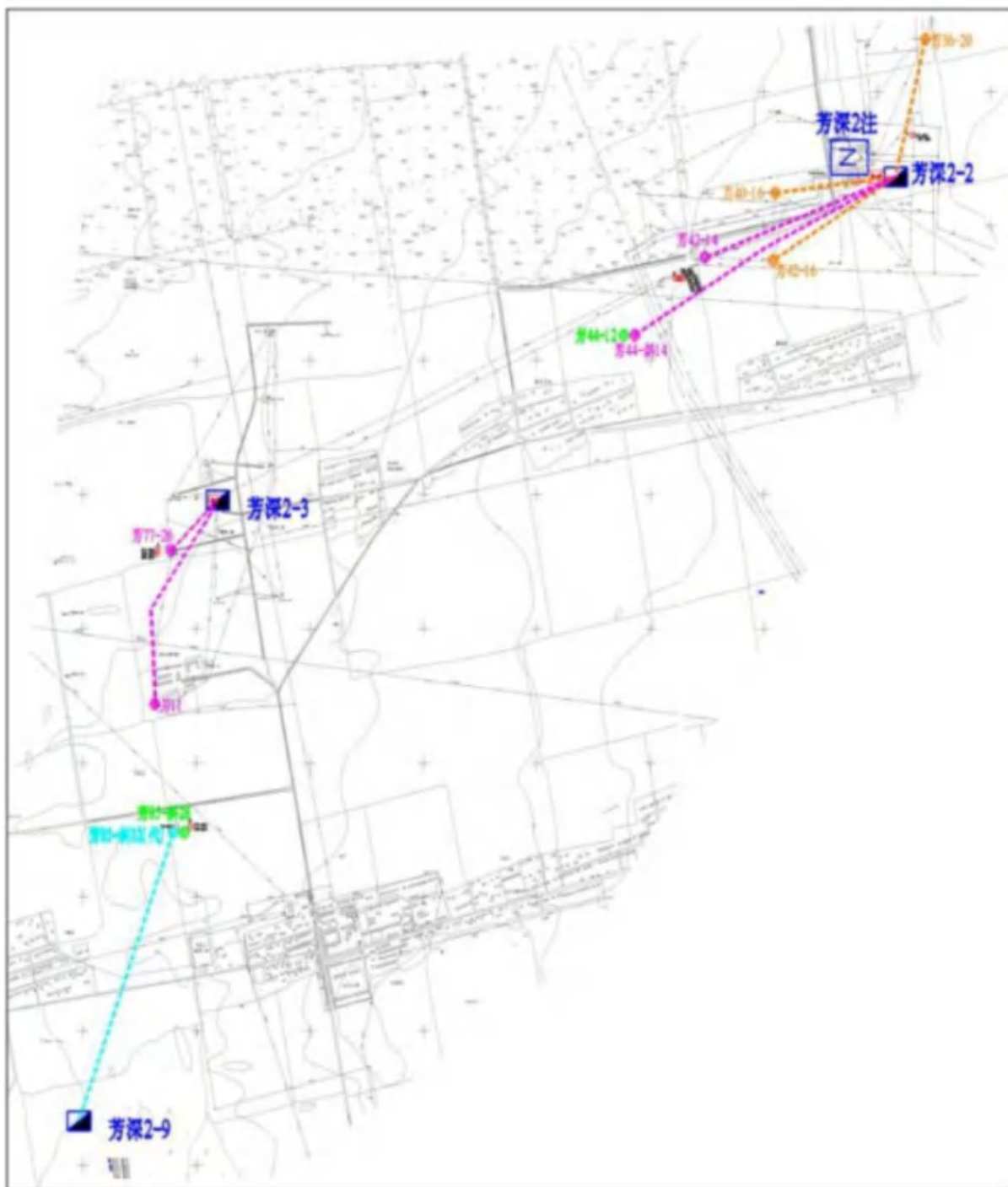
图 2.3-4（1） 注水井挂接配水间井网布置示意图
