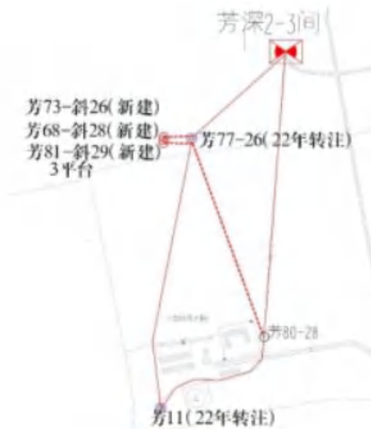
图 2.3-2（7） 芳深 2-3 阀组间新井搭接示意图
