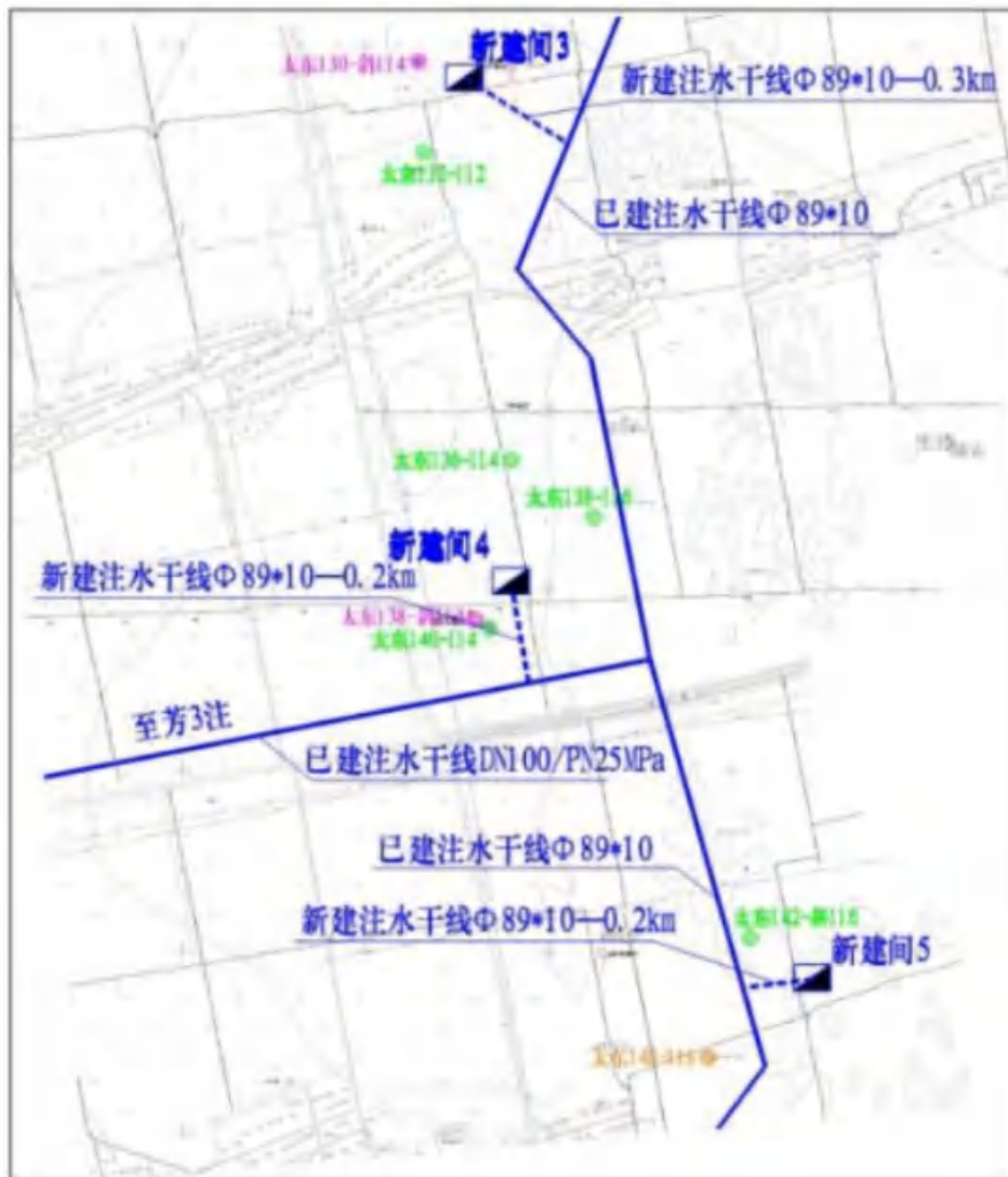
图 2.3-6（2） 新建注水干线布置示意图
