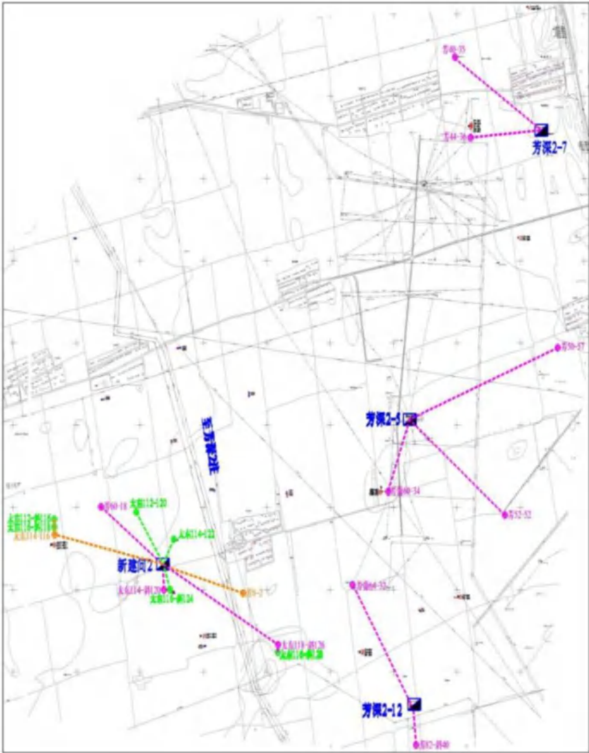
图 2.3-4（2） 注水井挂接配水间井网布置示意图
