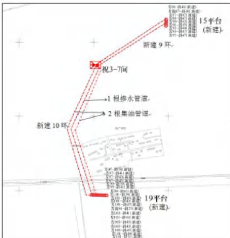
图 2.3-3 (3) 电加热 3 回路新井集油系统布局示意图
