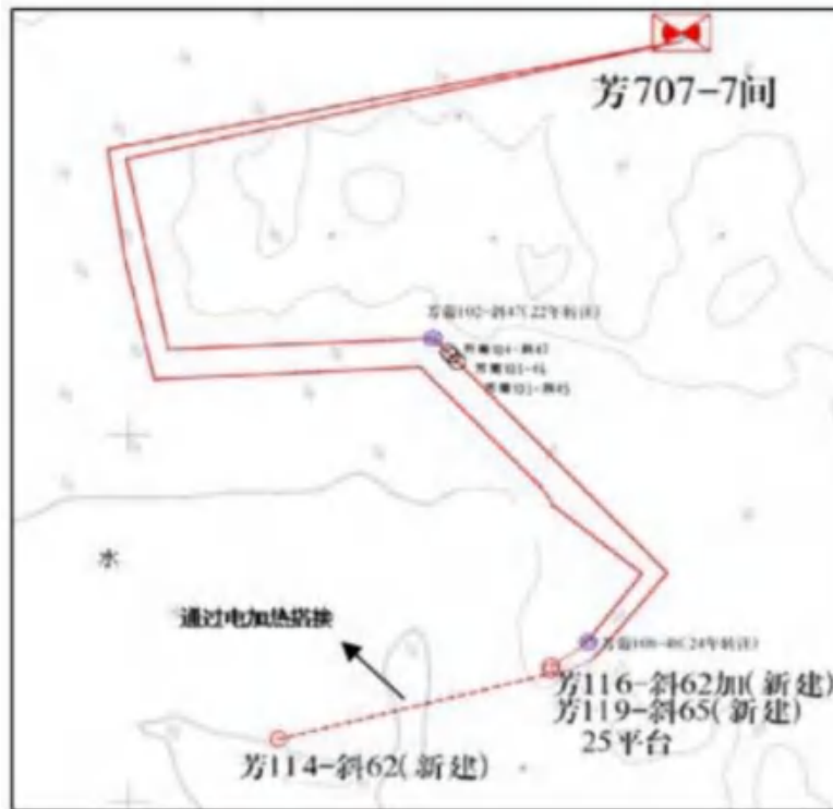
图 2.3-2 (12) 芳 707-7 阀组间新井搭接示意图
