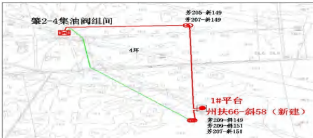
图 2.3-1 (1) 集油掺水管道布局走向图 (1#平台)
