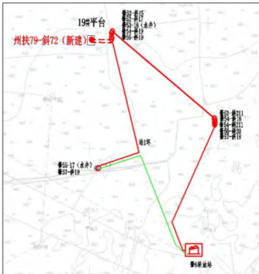
图 2.3-1 (8) 集油掺水管道布局走向图 (19#平台)
