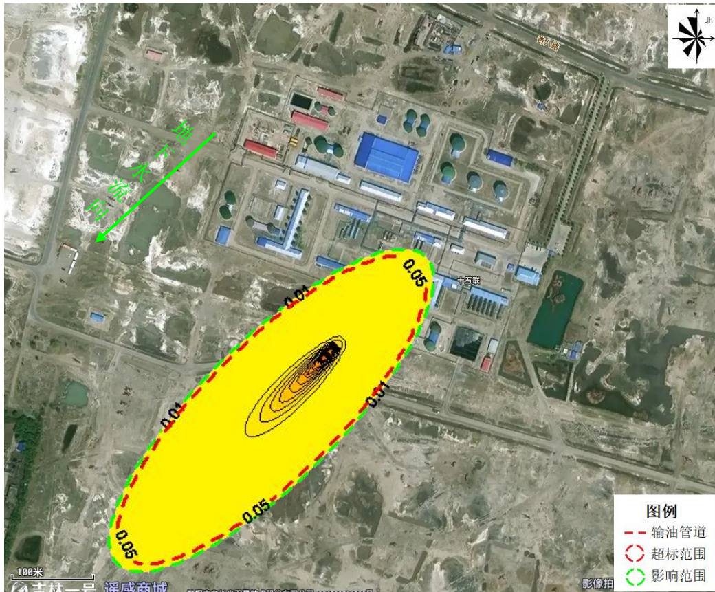
图 5.3-3 输油管道 10%管径泄漏后 5475d 污染物浓度分布图（污染源点：0，0）
