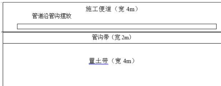
图 3.6-5 管道开挖施工平面布置示意图
