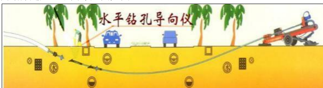
图 3.6-5 定向钻穿越施工示意图
