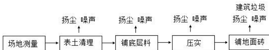
图3.3-3 场地施工流程及产污节点图
