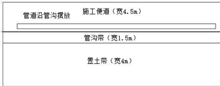
图 3.6-4 管道开挖施工平面布置示意图
