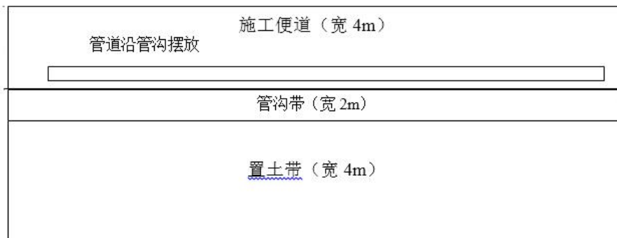
图 3.6-4 管道开挖施工平面布置示意图
