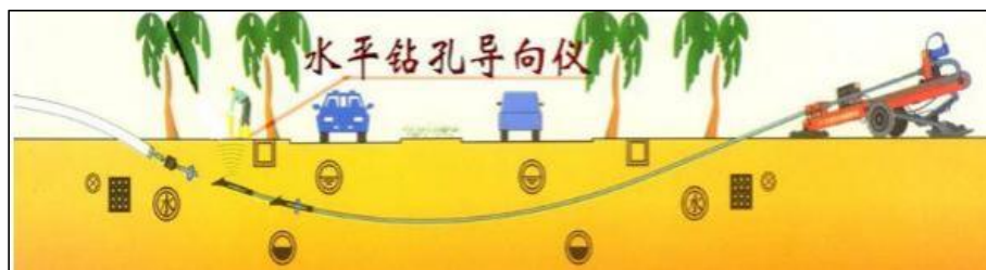
图 3.6-5 定向钻穿越施工示意图
