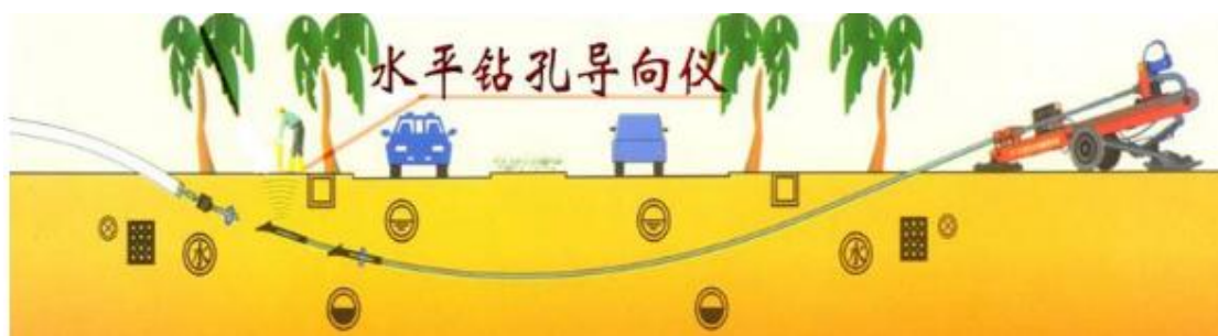
图 3.5-5 (1) 定向钻施工示意图
